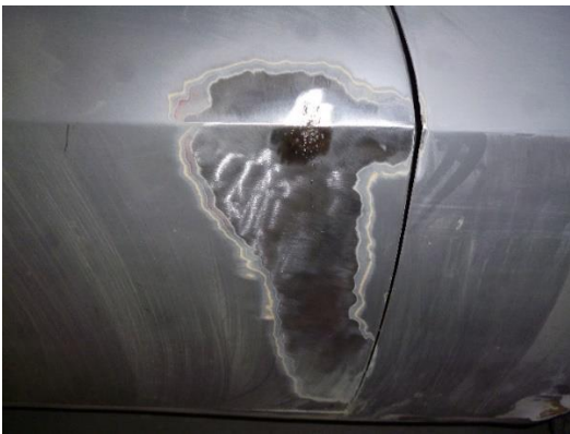
Resultaat van een tractie op een deur.
