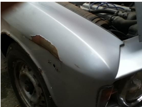
Voorste beschadigd spatbord.
