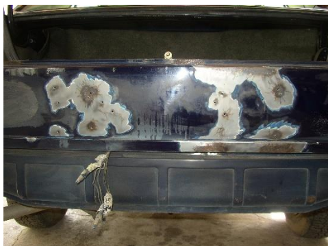
Voorbeelden van roest onder de verlaag
