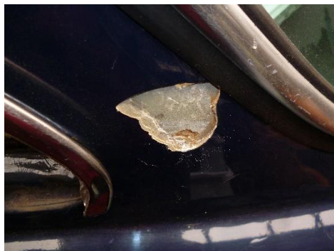
Voorbeeld van scheurtjes door plamuursel
