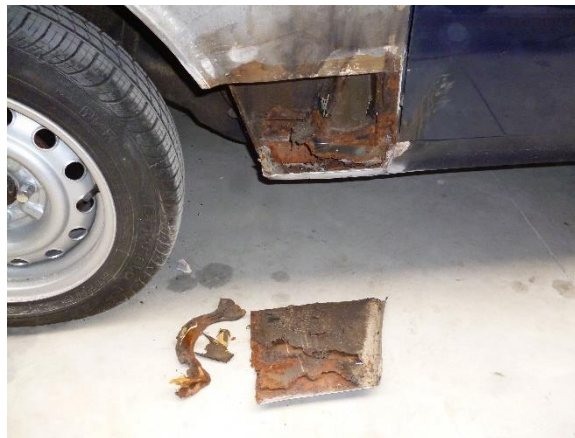
Voorbeeld van verroeste spatborden die herstelt werd met een dubbele plaat.
